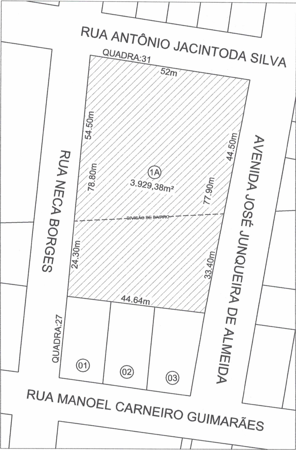
1 PLANTA DE SITUAÇÃO SEM ESCALA
